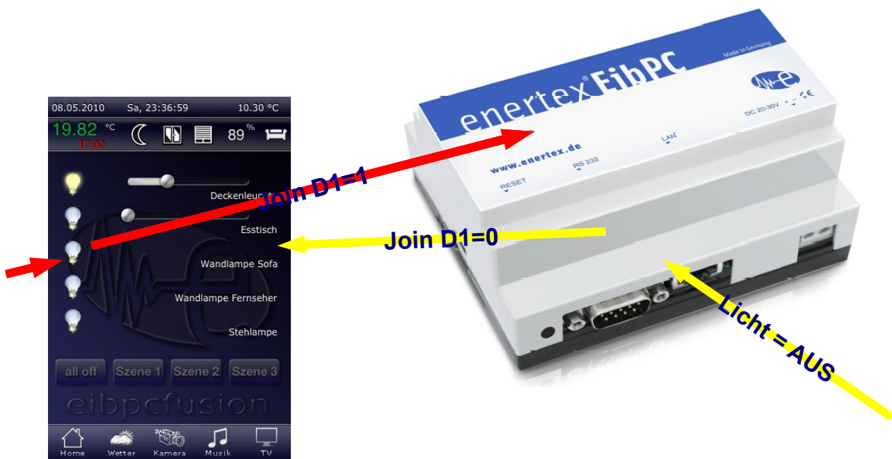
Abbildung 2: Grundsätzliche Kommunikation: Vom iPhone zum EibPC, vom KNX Bus zum EibPC und dann zum iPhone
